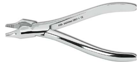
5801-1 DRITTA pinza universale indicata per la curvatura sia dei fili a sezione tonda che quelli a sezione mezzo tonda; piega fili fino ad un massimo di 0,9 mm e taglia fili fino ad un massimo di 0,7 mm.
