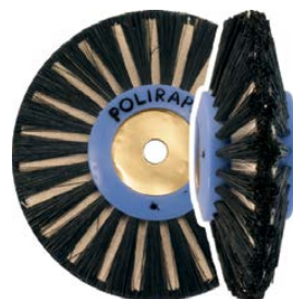
SPAZZOLA SUPREMA euro codice 4/40/80 MISTO TELA conf. 1 pz 8,65 00029791 Spazzola Suprema (extra dura) con 4 file di setole convergenti intercalate con dischi di tessuto. Particolarmente indicata per CrCo. Ø tot. 80 mm - Ø del centro 40 mm.
